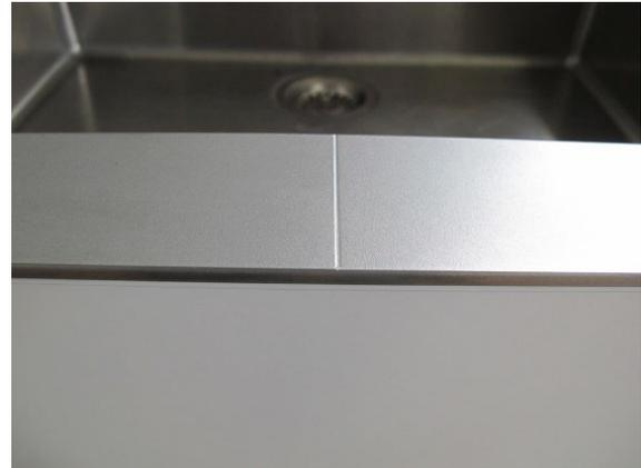
Laserschweißnaht in der Fläche
