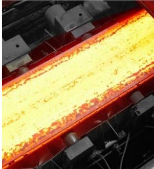
Die Oberfläche des warmgewalzten Edelstahls ist porös und unregelmäßig. Die Struktur der Oberfläche wird durch den Walzvorgang bestimmt und ist nicht beeinflussbar. Jede Edelstahlplatte, die aus dem Werk kommt, ist individuell – ähnlich wie eine Steinplatte mit natürlich gewachsener Struktur.
